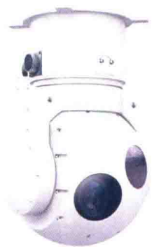
图 1-3 典型电力线路巡检用光电吊舱系统
