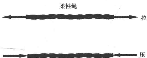
图 1-6 柔性绳受压不同于刚性杆示意图
