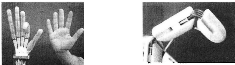
图 1-6 UB Hand 3 手和其手指结构图
