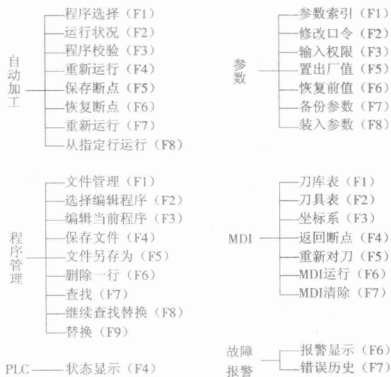
图 1.19 HNC-21M 的功能菜单结构
