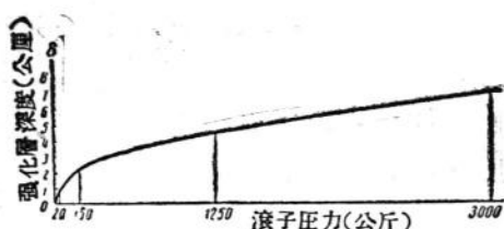
圖 13. 強化層深度與滾子上壓力的關係線束圖，車軸試樣直徑為 63 公厘，在三滾式輔具內滾壓，滾子直徑 150 公厘，為球狀工作面
