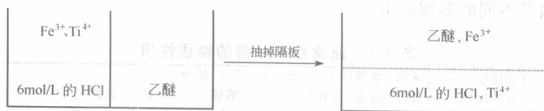
图 1-2 非均相体系中 \text{Fe}^{3+} 和 \text{Ti}^{4+} 的混合实验
