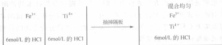
图 1-1 均相体系中 \text{Fe}^{3+} 和 \text{Ti}^{4+} 的混合实验
