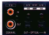
数码同轴接口、光纤接口 (全封闭的接口)
