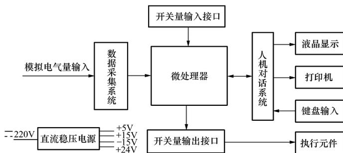
图 1-1 微机继电保护构成框图
