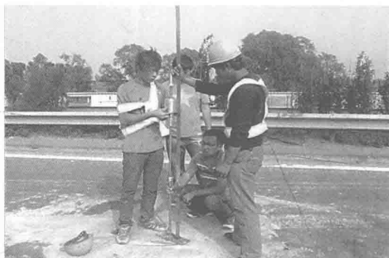
图 1.6 DCP 现场检测
