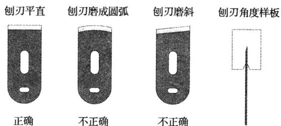
图 1-13 刨刃研磨后的检查和校正
