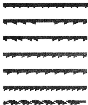
图 1-8 不同形状锯齿、不同用途的手工锯条
