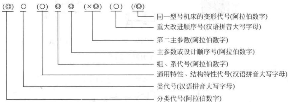
图 1-5 卧式车床型号表示及含义
