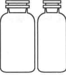
试剂瓶                                                                                         | 材料:玻璃或塑料<br>规格:分广口和细口;无色和棕色,以容积表示,如 $1500\text{cm}^3$ 、 $1000\text{cm}^3$ 、 $250\text{cm}^3$ 、 $100\text{cm}^3$ 等 | 广口瓶盛放固体试剂,细口瓶盛放液体试剂   | (1)不能加热<br>(2)取用试剂时瓶盖应倒放<br>(3)盛碱性溶液要用橡皮塞或者塑料瓶<br>(4)盛放见光易分解的物质用棕色瓶      |
