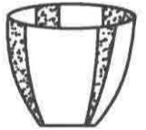
坩埚 | 材料:陶瓷、石英、银、铁、镍、铂等<br>规格:以容积表示,如 $50\text{cm}^3$ 、 $40\text{cm}^3$ 、 $30\text{cm}^3$ 等                             | 用于灼烧固体                | (1)灼烧时放在泥三角上,直接用火加热,不需用石棉网<br>(2)取下的灼热坩埚不能直接放在桌上,要放在石棉网上<br>(3)灼热的坩埚不能骤冷 |
