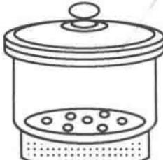
干燥器   | 以直径表示,如22cm、18cm等                                     | (1)定量分析时,将灼烧的坩埚置于其中冷却<br>(2)存放样品,以免吸收水分                | (1)灼烧物体放入干燥器前温度不能过高<br>(2)常检查干燥剂是否失效                         |
