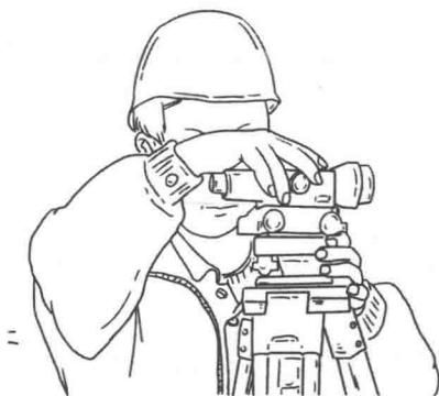
图 1-7 仪器安在三脚架上
