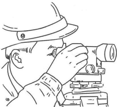
图 1-16 转动物镜调焦螺旋
