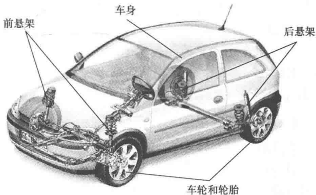
图 0-3 汽车行驶系统的组成
