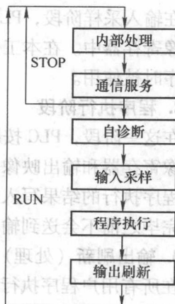
图 2-2 PLC 工作过程框图
