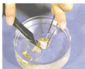
图12 冷却热饱和溶液， 硝酸钾从溶液中析出
