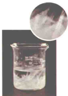
图12 冷却热饱和溶液， 硝酸钾从溶液中析出
