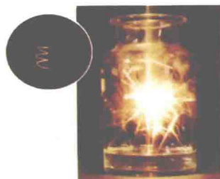
图15 铁丝(左)、硫(右)在氧气中燃烧
