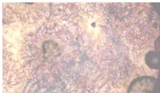
图 2-35 奥—贝斜铁等温淬火组织，钼酸钠水溶液 (500×)
