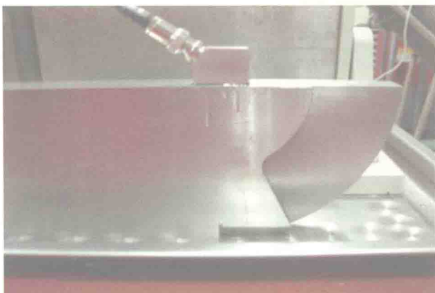
图 5-45 用 CSK-IA 试块测试斜探头入射点的图片
