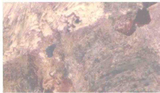
图 2-38 T7 工具钢退火组织，焦亚硫酸钾溶液着色 (640×)
