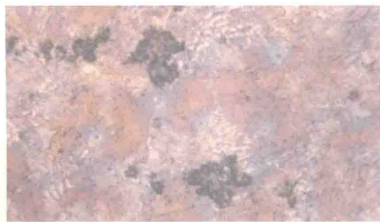
图 2-36 可锻铸铁石墨化退火组织，化学染色 (500×)
