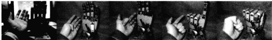
图 3 基于肌电信号的多自由度假手控制
