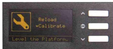
**2** 选择自动调平时，喷嘴将下降至平台附近进行自动校准，校准完成后，打印机操作菜单会返回至主菜单界面。
