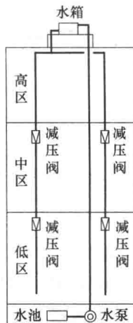
沿垂直立管循序减压给水方式
