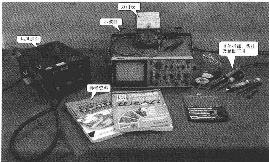
图 1-1 数码影音产品的维修器材和设备
