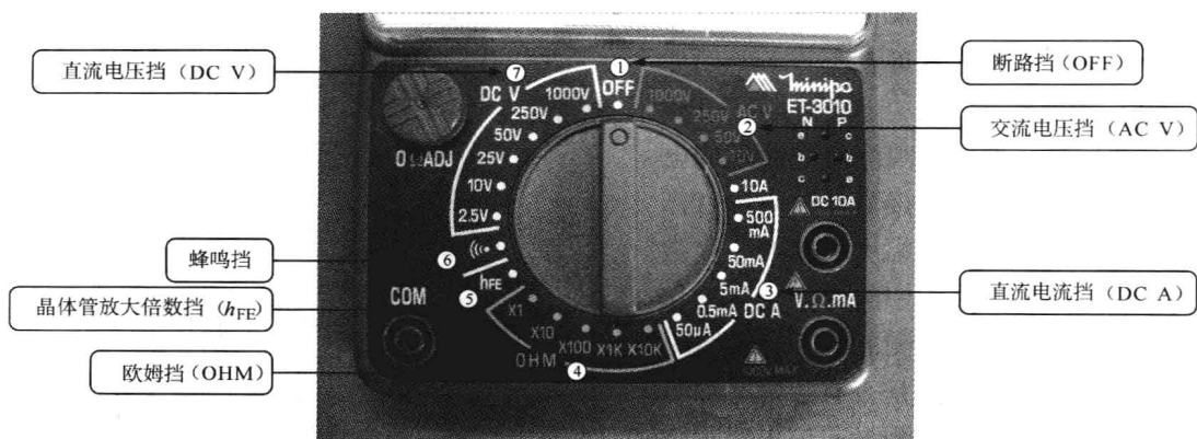
图1-7 万用表的功能调节旋钮
