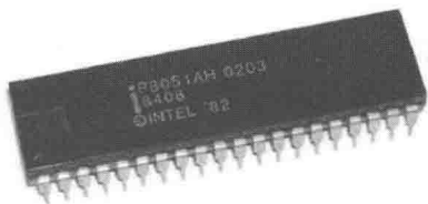
图 1.2 当前 Intel 公司的一款 8051 单片机(DIP40 封装)
