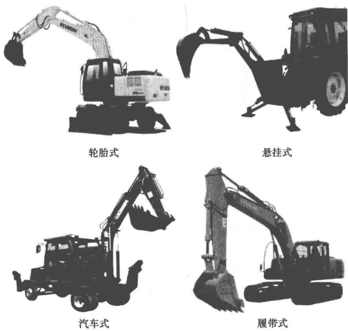
图 2-8 挖掘机行走机构（履带式、轮胎式、汽车式、悬挂式）
