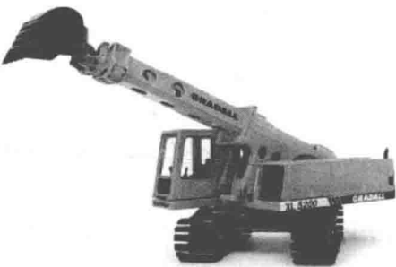
图 2-5 伸缩臂工作装置
