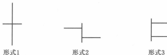
图 1-3 “半导体区,具有多处接触”的三个形式
