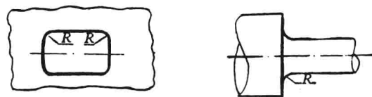
图 2-2 减小应力集中的措施
