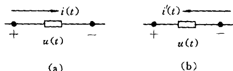
图 1-3-1 说明电路元件的功率的图
