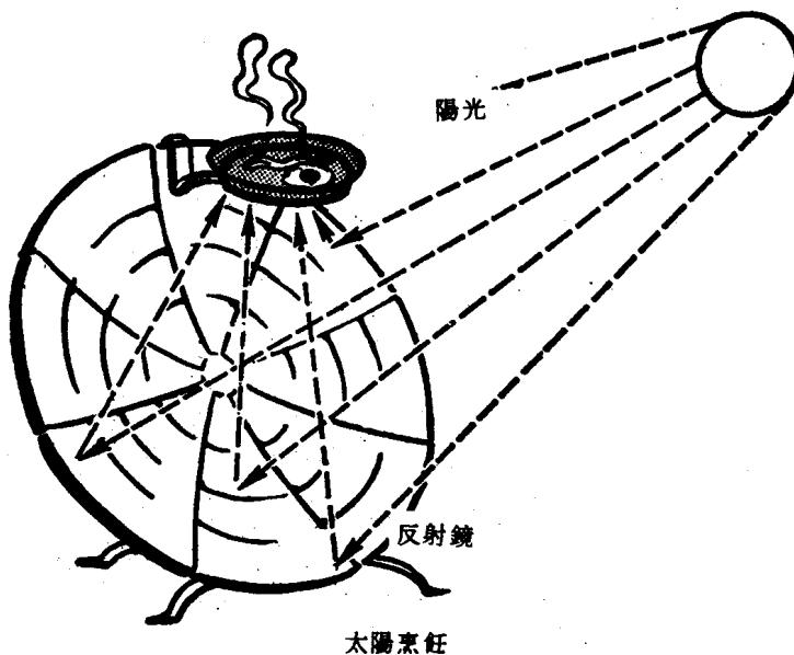
在美國，市面上可以買到一種使用太陽能的烤肉用烹飪器。這種烹飪器，為便於攜帶，可以像雨傘似地摺疊起來。使用時，我們在陽光下把它打開，並倒擰在地面上，這樣，就變成一具很有效的聚熱器了。它可以把陽光聚焦在傘柄附近，以烤熟熱狗。
