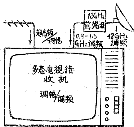
图3 能接收0.9—1.3千兆赫间的调频信号多态电视接收机，它是家用卫星接收机中最感兴趣的结构之一。
