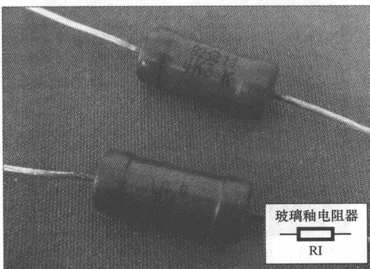
**特点：**将银、铑、钌等金属氧化物和玻璃釉黏合剂调配成浆料，喷涂在绝缘骨架上，使用高温对其进行聚合而成，具有耐高温、耐潮、阻值范围大等特点。
