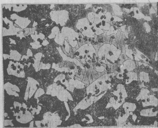
图 5 DC45 断口导边压力面的金相组织： \alpha + \beta + 富铁相（黑点） \times 100
