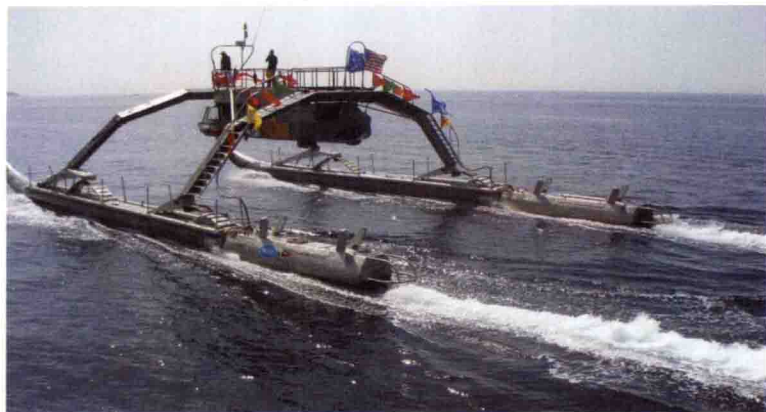
美国海军最近研制的具有穿越大洋的能力，最大航行距离为5000英里（8046.72公里）“波浪适应模块船”——“普洛透斯”号
