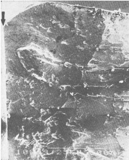
图15 63× 涡轮叶片疲劳断口疲劳源区的形貌。
