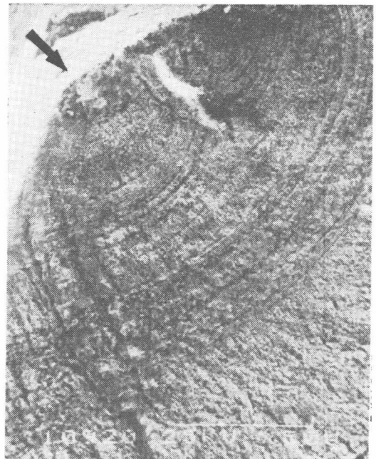
图16 500× 左图疲劳源区的进一步放大， 可以看到细密的疲劳条纹。
