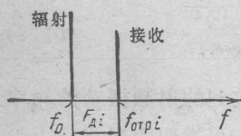
图1.6 回波振荡 在频率轴上的频移
