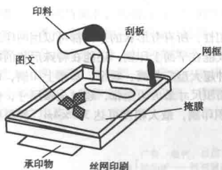
图 1-7 网版印刷原理示意图
