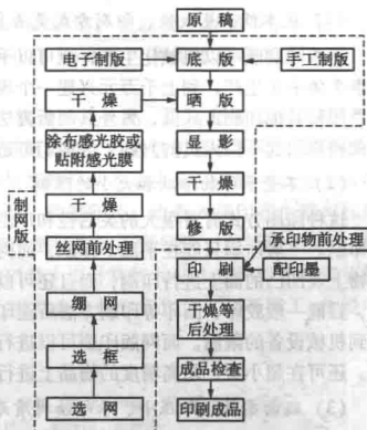
图 1-8 网版印刷的工艺流程
