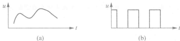
图 1.2 模拟信号和数字信号的波形
