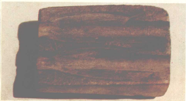
早于公元前16世纪的铸造铜器的石范(甘肃玉门火烧沟出土)
