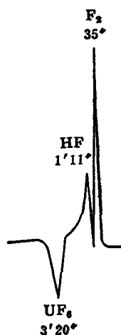
图 6 0.5 米铜柱 \text{F}_2 , \text{HF} , \text{UF}_6 的分离峰
