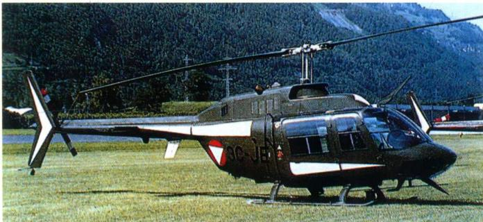
贝尔 206 是美国原贝尔直升机公司（现信达集团贝尔直升机公司）研制的 5 座单发轻型通用直升机。1966 年 1 月首飞，1968 年 3 月投入使用。有贝尔 206A、贝尔 206B“喷气突击队员”II、贝尔 206B“喷气突击队员”III、贝尔 206L、TH - 57A/B/C、OH - 58A/B/C/D 等。奥空军装备 12 架贝尔 206A
