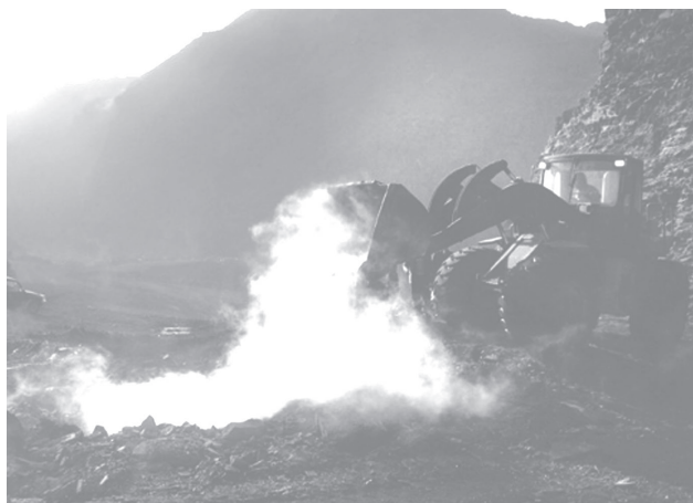
图4 积层增温导致煤层自燃
