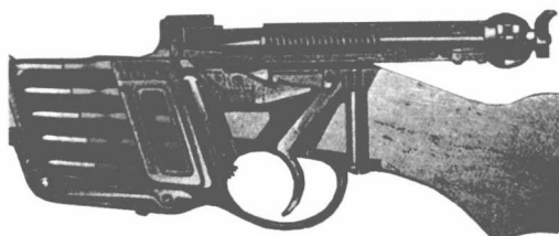
19世纪末奥地利曼利夏步枪的弹仓结构设计对步枪供弹系统的设计产生了深远影响
