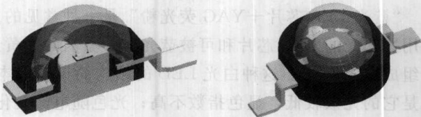
图 1-3 大功率 LED 结构
