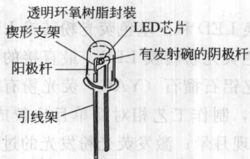
图 1-2 小功率 LED 结构
