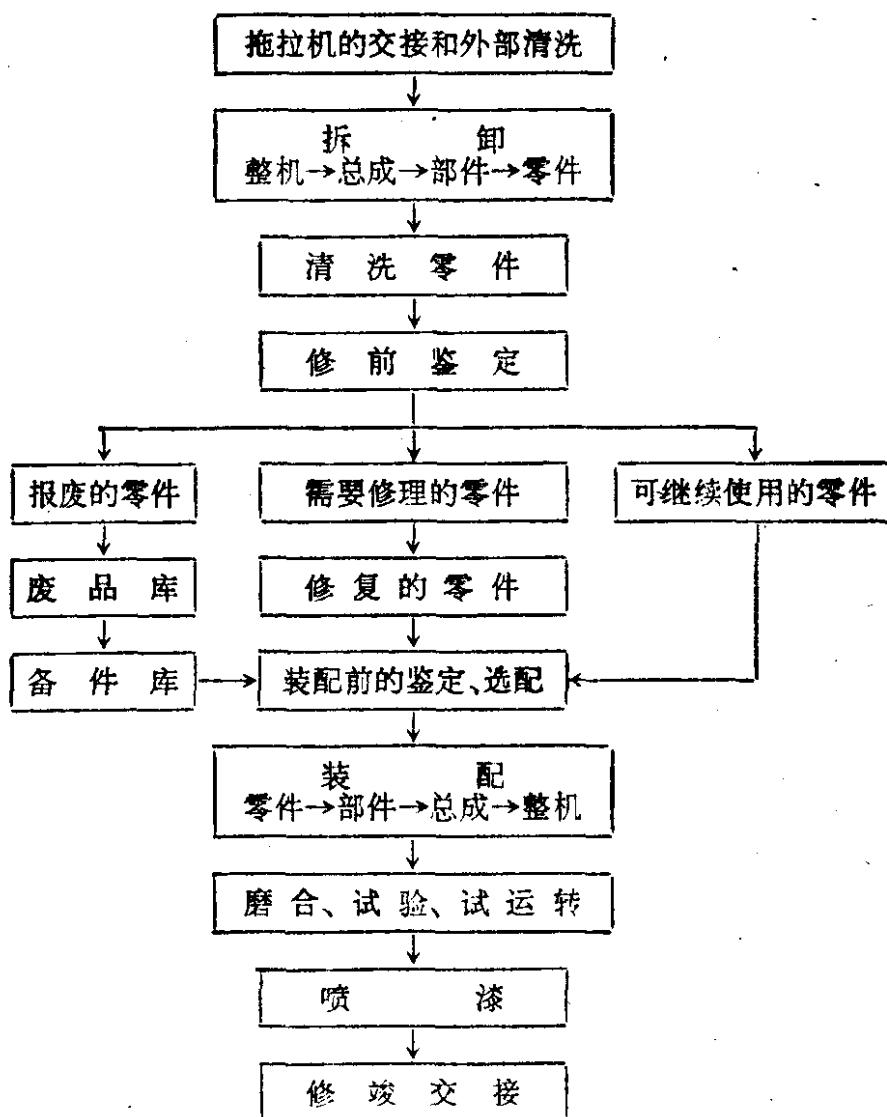
送修的拖拉机，在交接过程中，应由修理厂的有关人员与送修者一起对拖拉机的完整性和技术状态进行检查，共同商定修理的内容。
