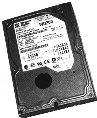
图 1.1 硬盘的外部结构
