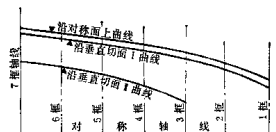
图 1-4 垂直切面纵向模线示意图
