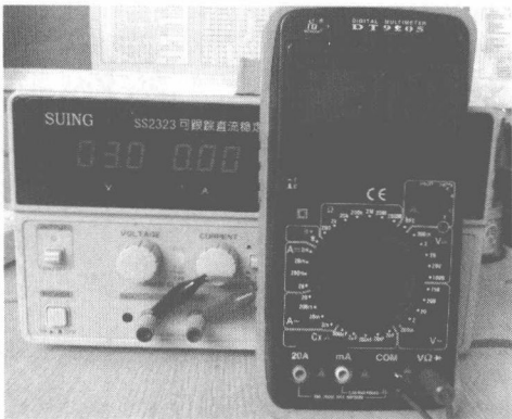
图 1.1.4 数字万用表测量直流电压
