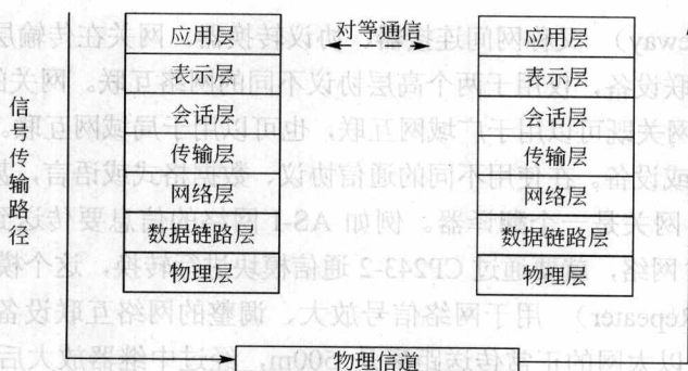
图 1-2 信息在 OSI 模型中的流动形式
