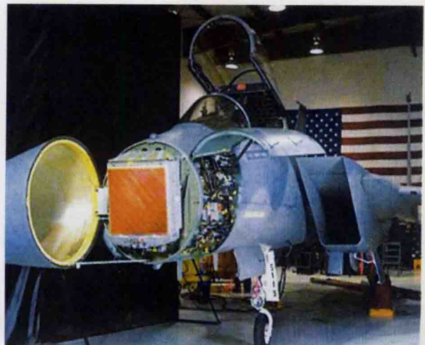
美国 AN/APG-63 (V) 2 相控阵雷达安装在 F-15C 飞机上
