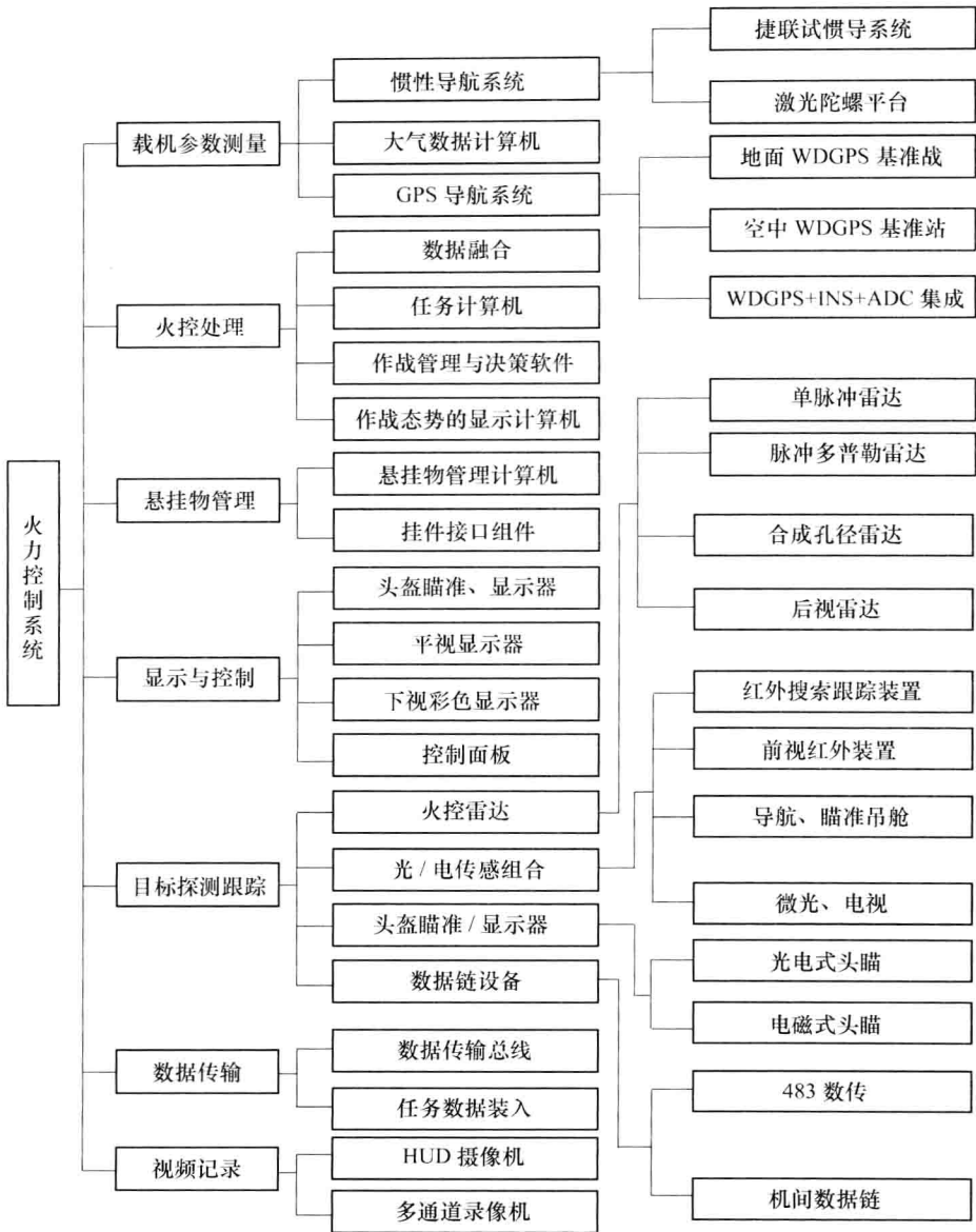
图 1-1 火力控制系统的基本组成
