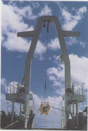
下放深海拖曳式光学探测器
