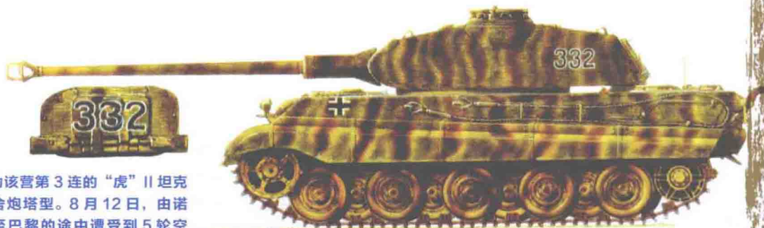
隶属于503重坦克营第1连的“虎”II坦克波尔舍炮塔型。1944年法国诺曼底战役。该营炮塔后部舱口涂装有本车的编号，同时都铺设防磁装甲。
